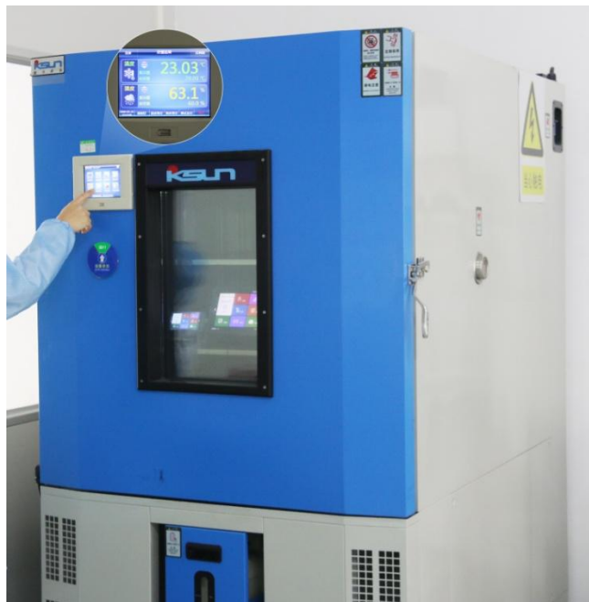
图 5-3 高低温老化测试图
